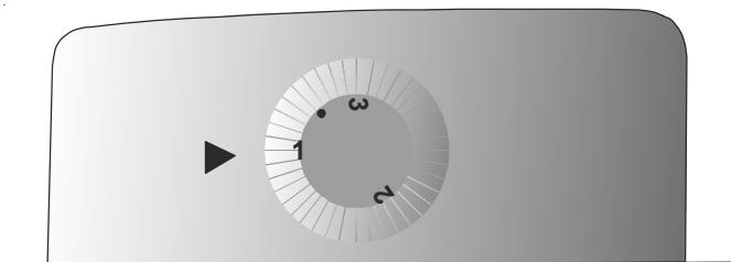
Termostat zamrzivača automatski regulira unutarnju temperaturu u odjeljcima. Rotiranjem ručice na položaje od 1 do 3 može se postići još hladnija temperatura. Položaj “•” pokazuje kako je termostat zatvoren te hlađenje nije moguće.
