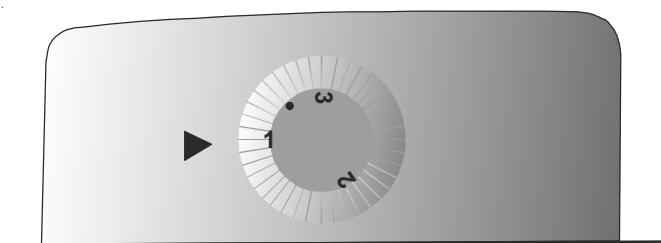
Termostat u zamrzivacu automatski regulise temperaturu u zamrzivacu. Okretanjem prekidaca moze se regulisati temperatura.
